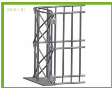
Verschrauben Sie die Gittermatten mit den Säulen. Die Gittermatten müssen mit dem Boden abschließen. Die Befestigung erfolgt mittels Universalklemmen [Grafik 3], die Sie oben und unten gleichmäßig verteilt montieren (handfest anziehen).
